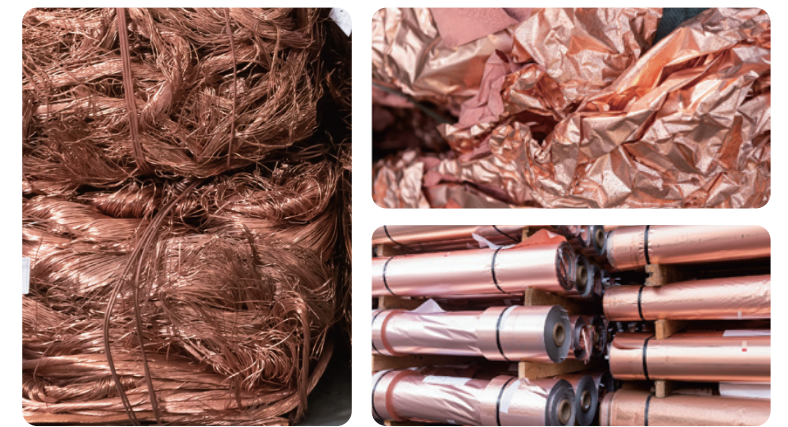
▲ 100% 使用回收電線 / 電纜的廢銅線，以及廠回收的 Z 級品 / 裁切的邊角料當作溶銅的原物料，將可再生利用資源物盡其用，提高產品的使用效益，超越客戶要求，邁向淨零排放。
